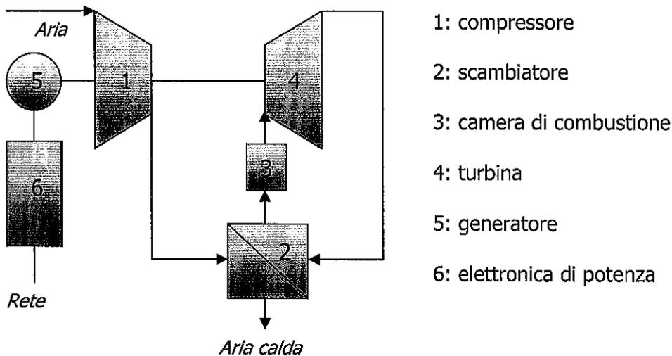
Figura 1: Principio di funzionamento di una microturbina
